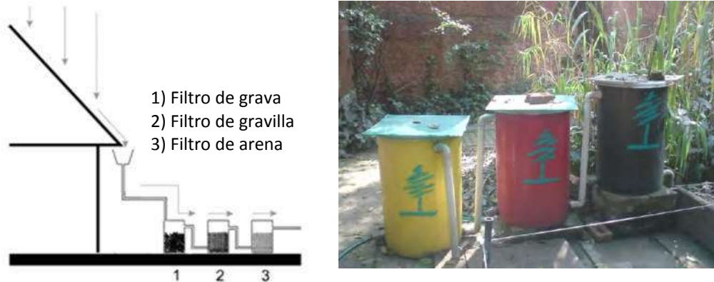
Figura 2.4. Sistema de captación de lluvia de la casa ecológica del parque Loreto y Peña Pobre, Ciudad de México.
