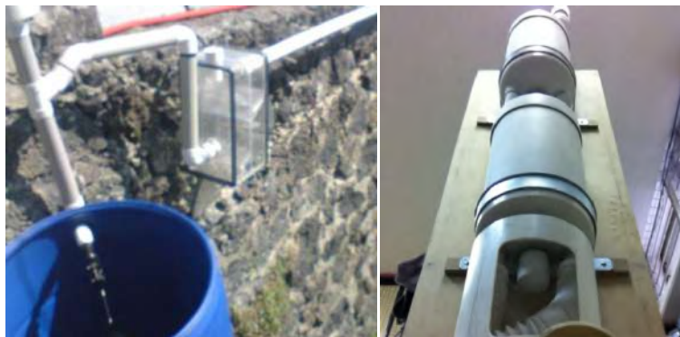
Figura 5.6. A la izquierda un desarenador rectangular transparente y a la derecha uno cilíndrico propuesto por Chacón et al. (2011).
